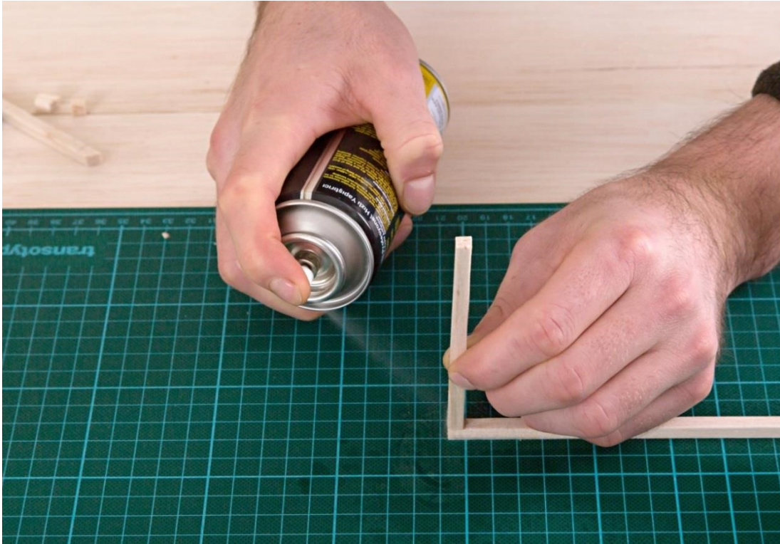
Şekil E6. Yapıştırma hızlandırmak için sıkılan spreyl aktivatör (her yapıştırma işleminde uygulanması tavsiye edilir)
