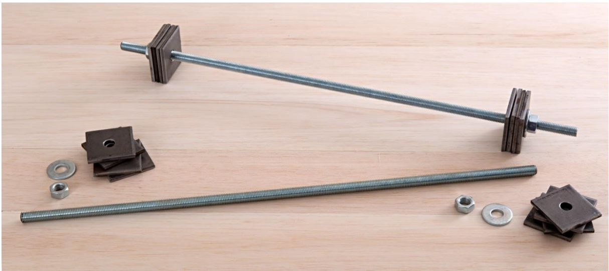
Şekil E2. Kat ağırlığını oluşturan parçalar
