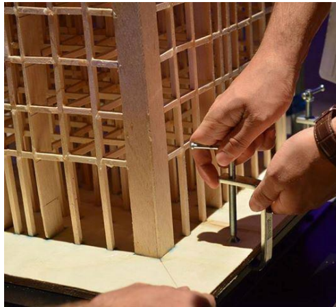
Şekil A4. Bina maketinin taban plakası seviyesinden sarsma masasına montajı
