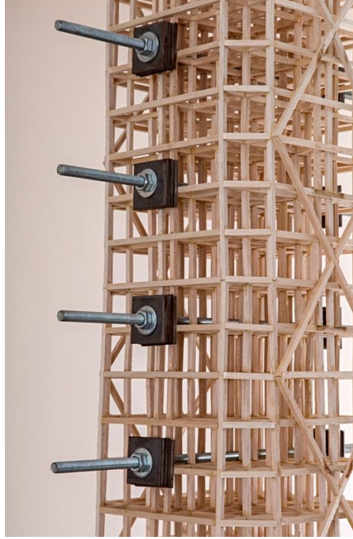
Şekil E11. Kat ağırlığı bağlantıları (her 15cm'de bir)
