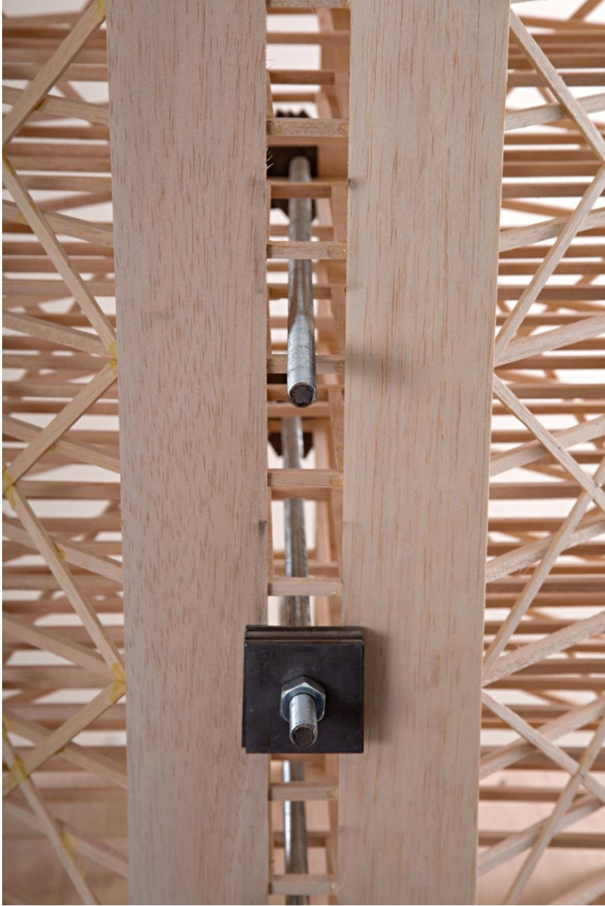
Şekil E15. Kat ağırlık çubuğu en az 1.3cm; en çok 1.6cm genişliğinde bir boşluktan geçirilerek sıkıştırılmalıdır. Bu fotoğrafta YANLIŞ BİR UYGULAMA olarak gereğinden fazla boşluk bırakılmıştır.
