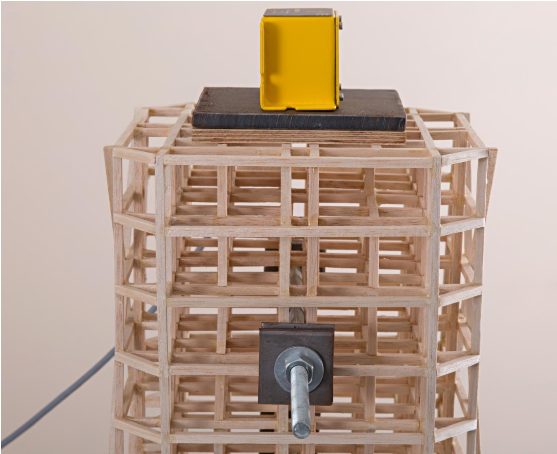
Şekil E14. Çatı ağırlığını oluşturan tüm unsurlar (ahşap plaka, çelik levha ve ivmeölçer)
