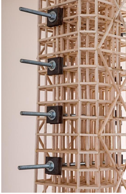
Şekil E11. Kat ağırlığı bağlantıları (her 15cm'de bir)
