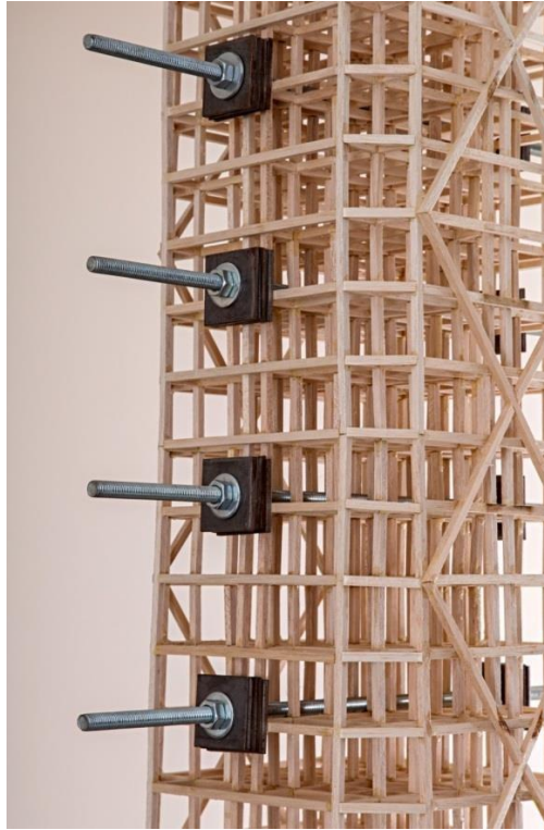
Şekil E.10. Kat ağırlığı bağlantıları (her 18 cm’de bir)
