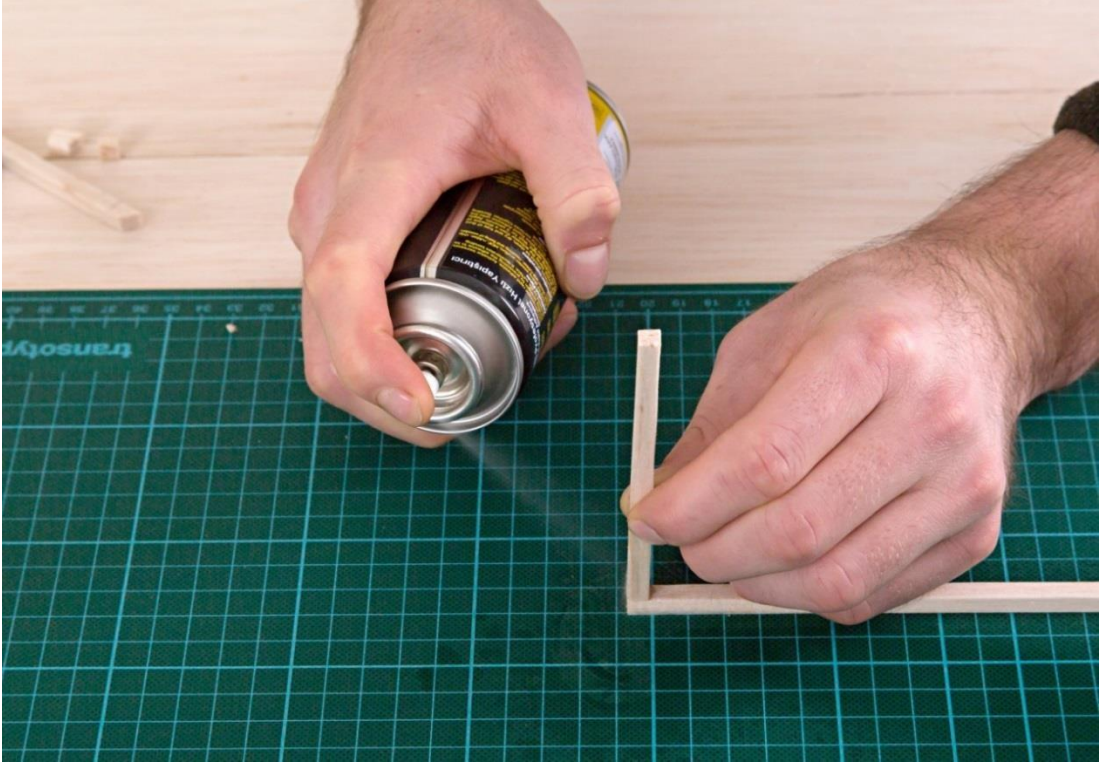
Şekil E.6. Yapıştırmayı hızlandırmak için sıkılan spreysel aktivatör (her yapıştırma işleminde uygulanması tavsiye edilir)
