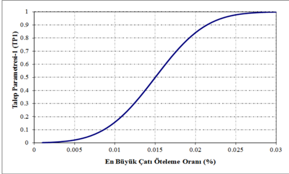
Şekil 6.1. En büyük çatı öteleme oranı ile yapısal hasar kaynaklı kaybı ilişkilendiren kayıp fonksiyonu
