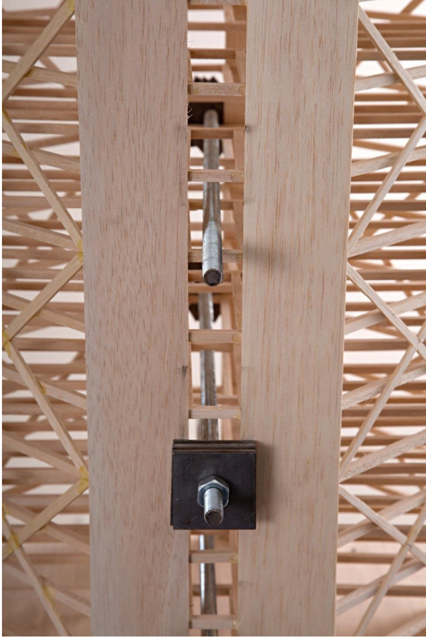
Şekil E.14. Kat ağırlık çubuğu en az 1,3 cm, en fazla 1,6 cm genişliğinde bir boşluktan geçirilerek sıkıştırılmalıdır. Bu fotoğrafta YANLIŞ BİR UYGULAMA olarak gereğinden fazla boşluk bırakılmıştır.
