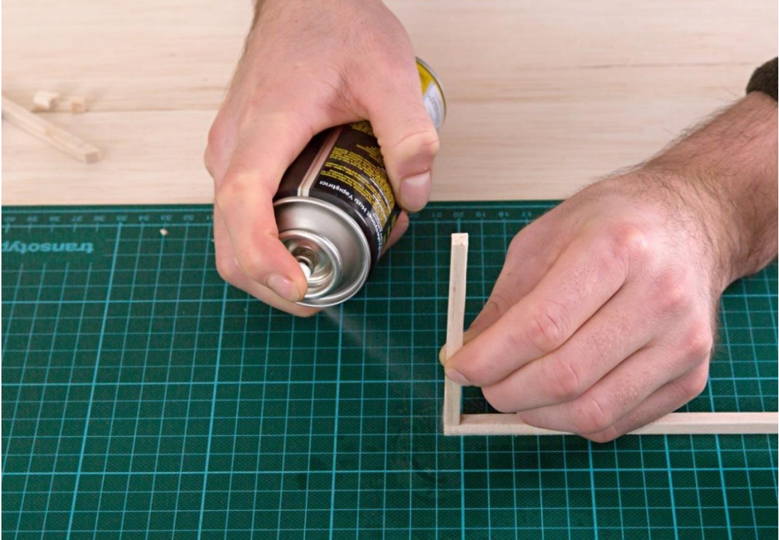
Şekil E.6. Yapıştırmayı hızlandırmak için sıkılan spreylen aktivatör (her yapıştırma işleminde uygulanması tavsiye edilir)
