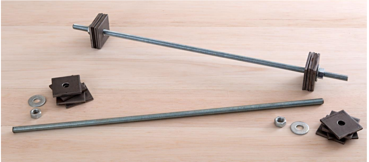
Şekil E.2. Kat ağırlığını oluşturan parçalar
