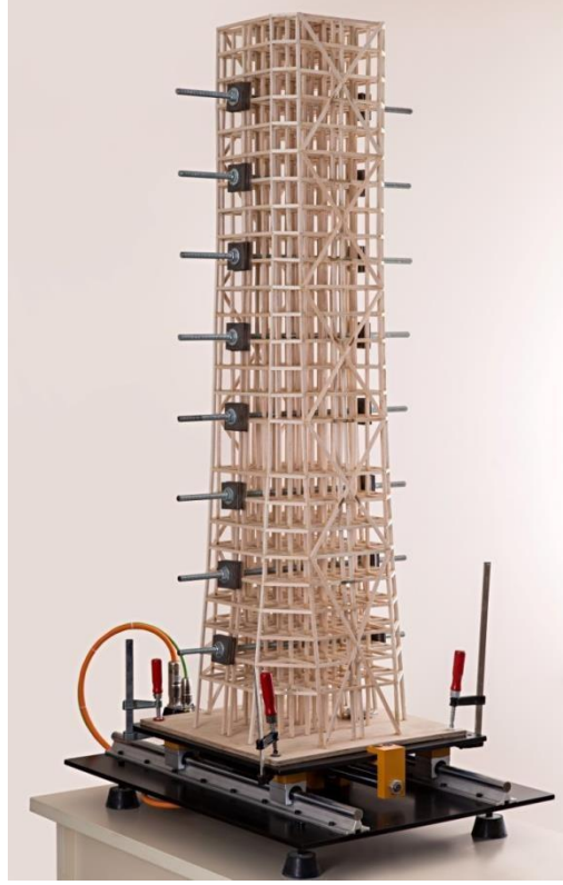
Şekil E.11. Sarsma masası üzerinde kat ağırlıkları ile birlikte maket bina
