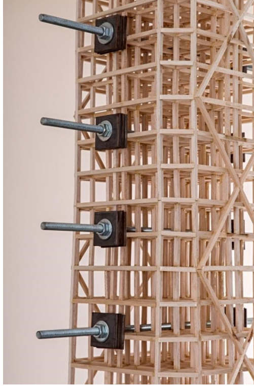
Şekil E.11. Kat ağırlığı bağlantıları (her 18 cm'de bir)
