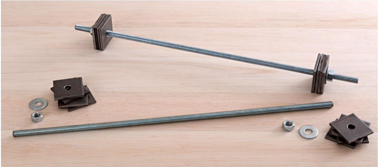
Şekil E.2. Kat ağırlığını oluşturan parçalar
