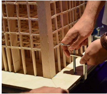
Şekil A.4. Bina maketinin taban plakası seviyesinden sarsma masasına montajı
