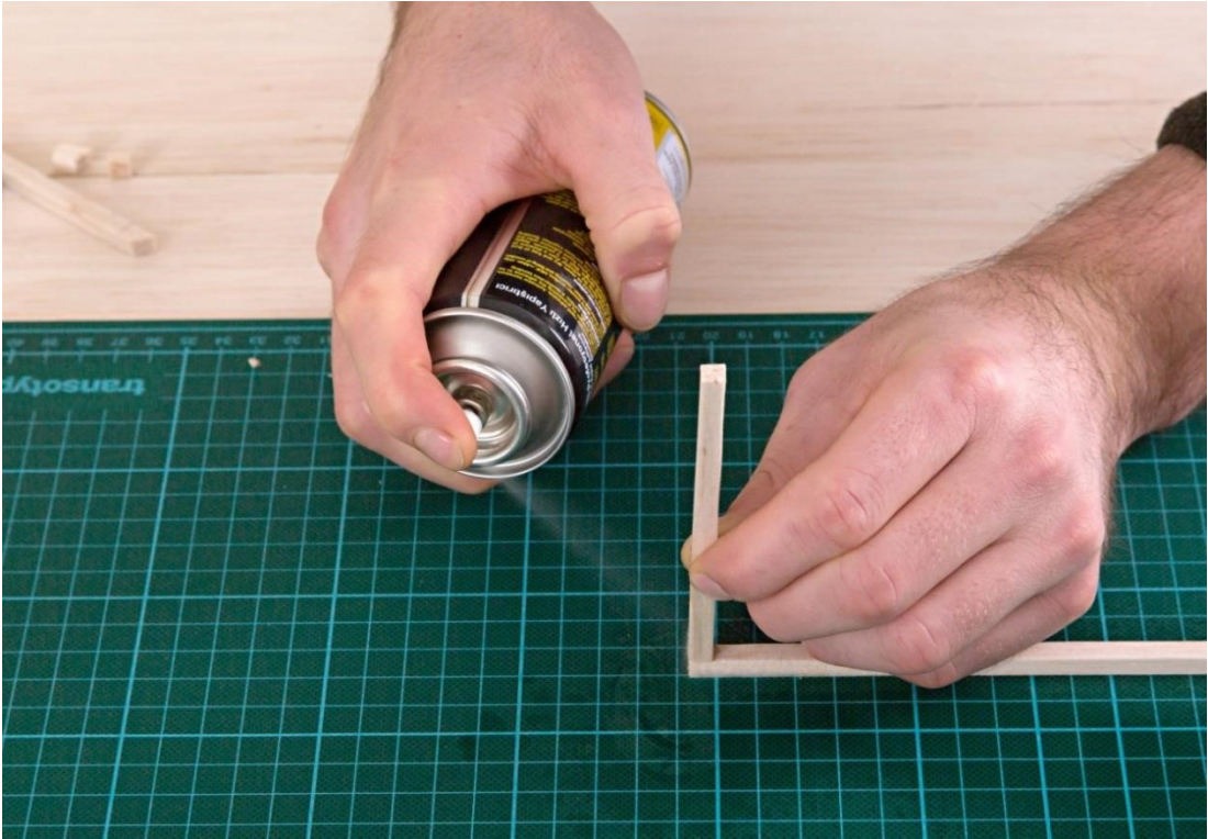
Şekil E.6. Yapıştırma hızlandırmak için sıkılan spreylenmiş aktivatör (her yapıştırma işleminde uygulanması tavsiye edilir)
