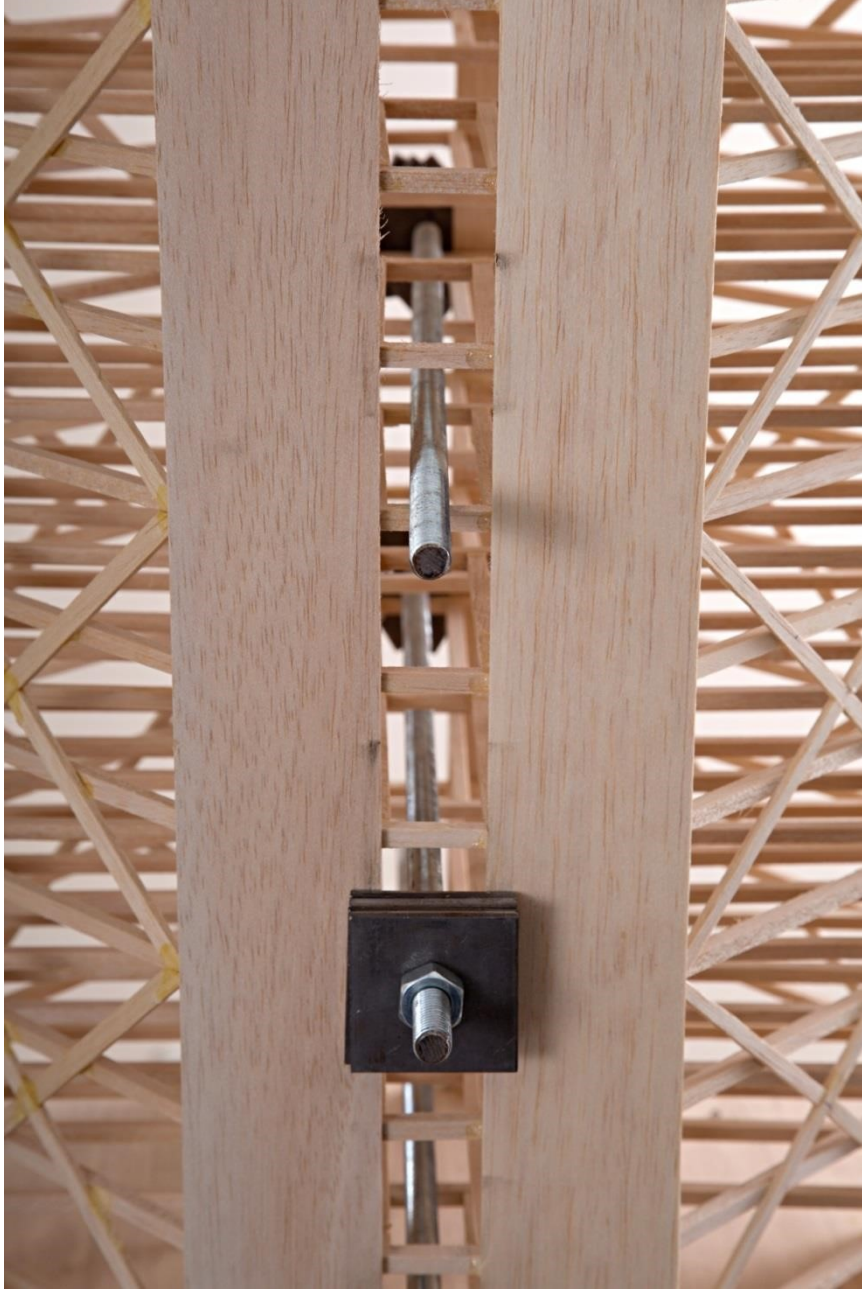
Şekil E.15. Kat ağırlık çubuğu en az 1,3 cm, en fazla 1,6 cm genişliğinde bir boşluktan geçirilerek sıkıştırılmalıdır. Bu fotoğrafta YANLIŞ BİR UYGULAMA olarak gereğinden fazla boşluk bırakılmıştır.
