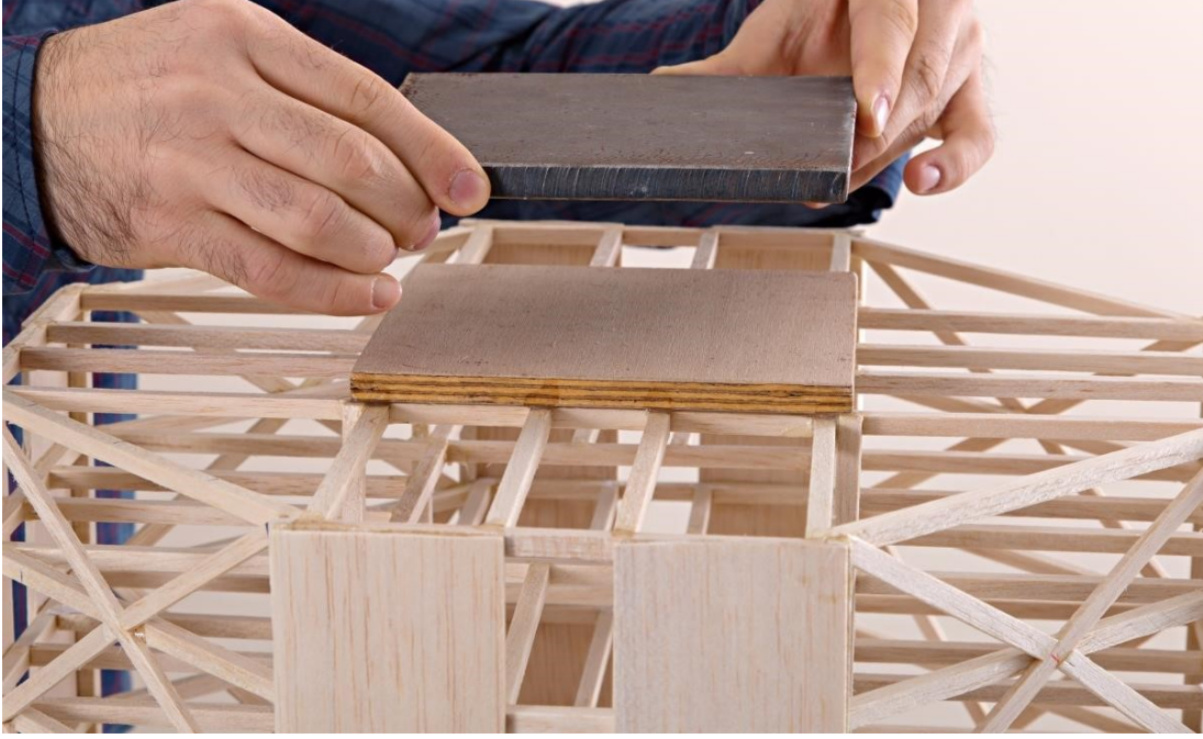
Şekil E.13. Ahşap çatı plakası (yapıştırılmış) ve metal çatı levhası makete takımlar tarafından yapıştırılarak rijit bir şekilde makete sabitlenecektir.
