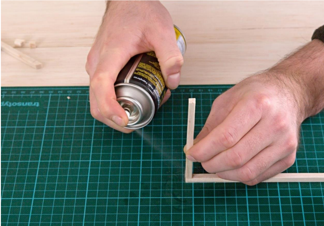
Şekil E6. Yapıştırmaı hızlandırmak için sıkılan spreı aktivatör (her yapıştırma işleminde uygulanması tavsiye edilir)
