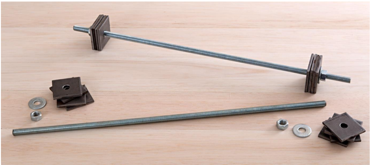
Şekil E2. Kat ağırlığını oluşturan parçalar
